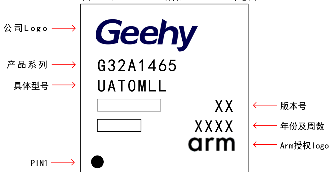
图 9 LQFP100 – 100 引脚，14 x 14mm 示意图
