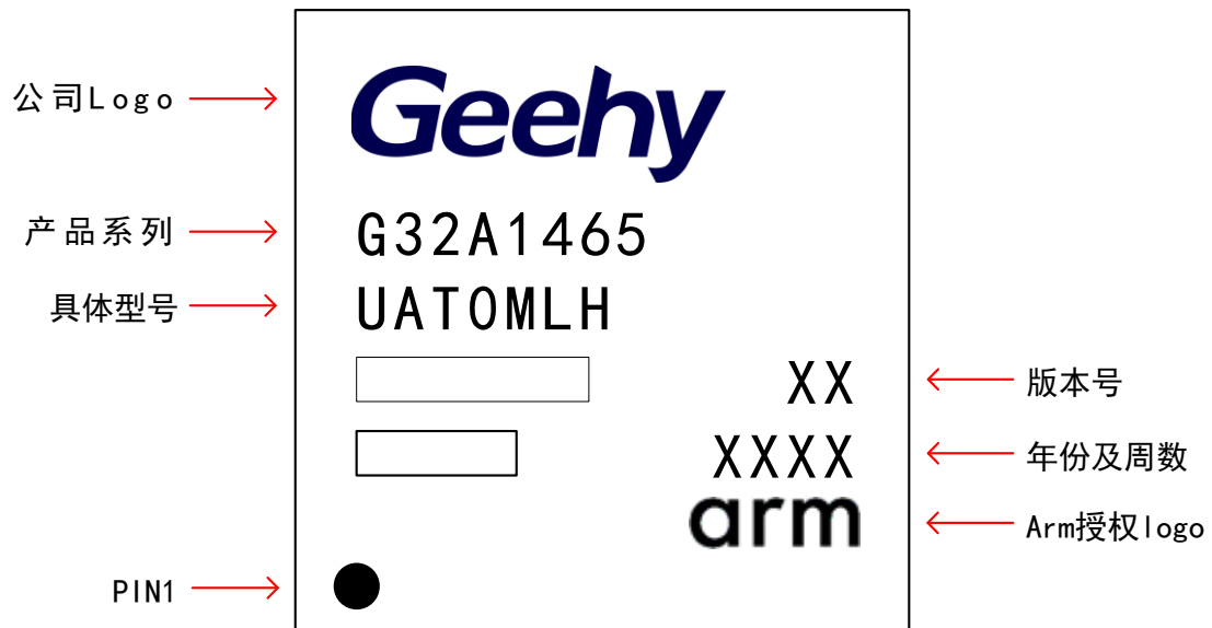
图 12 LQFP64 – 64 引脚，10 x 10mm 示意图
