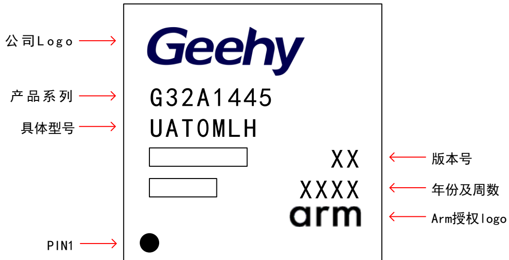
图 12 LQFP64 – 64 引脚，10 x 10mm 示意图
