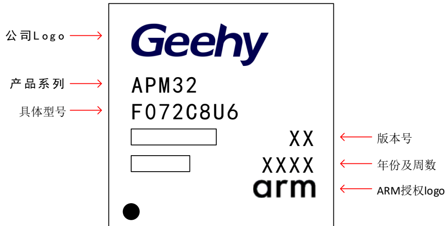
图 27 QFN48 打码规范
